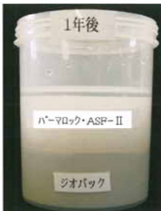
ジオバックとパーマロック ASF-II のホモゲル相性試験 1年後にも変化は見られない
